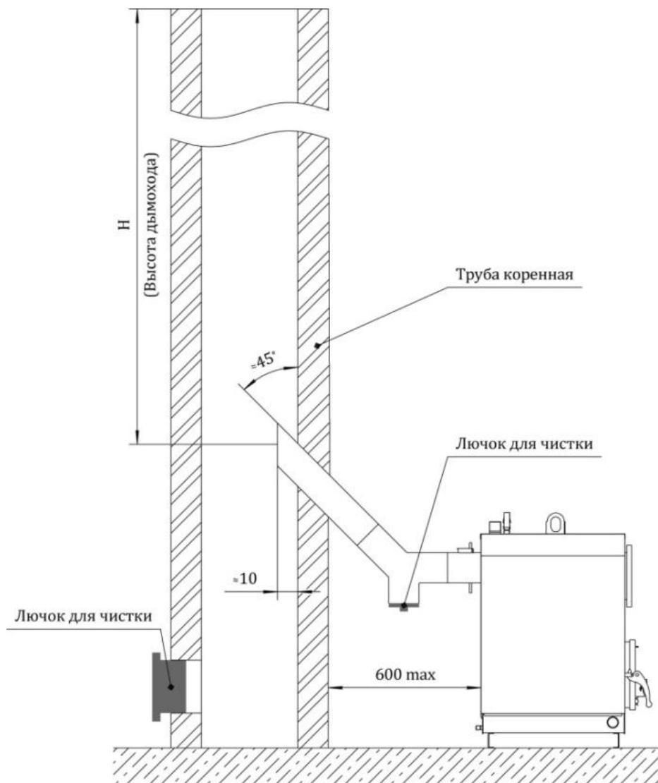
**Рисунок 6 – Вариант подключения котла с горизонтальной дымовой трубой**
