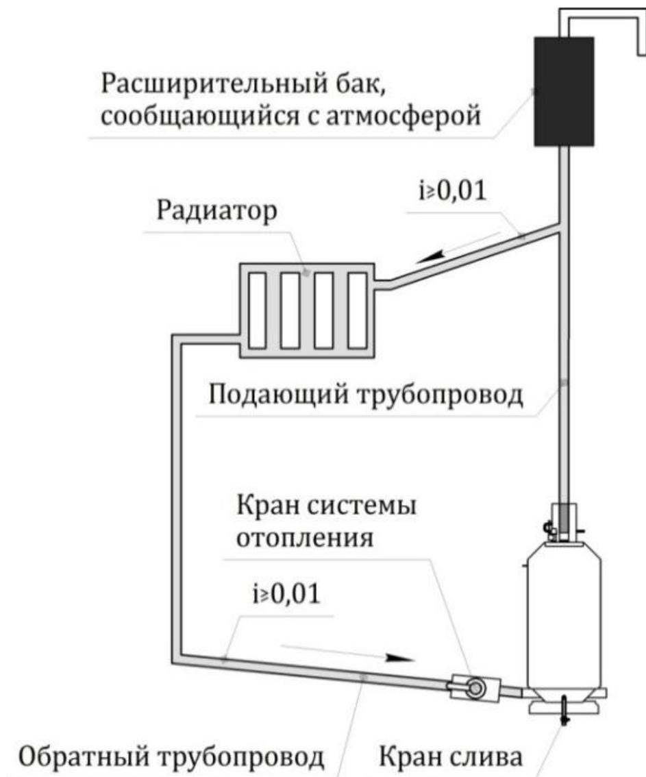
Рисунок 8 – Схема открытой системы отопления с естественной циркуляцией
