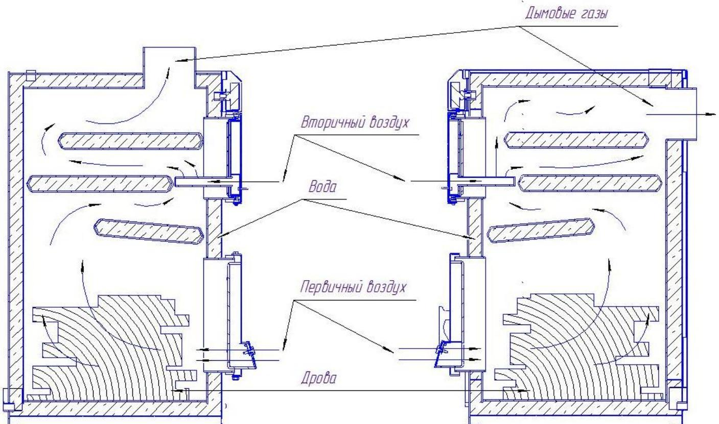
Рисунок 1.1 – 3-х ходовая схема котлов GreenКОД-25 (слева) и GreenКОД-25 гт (справа)
