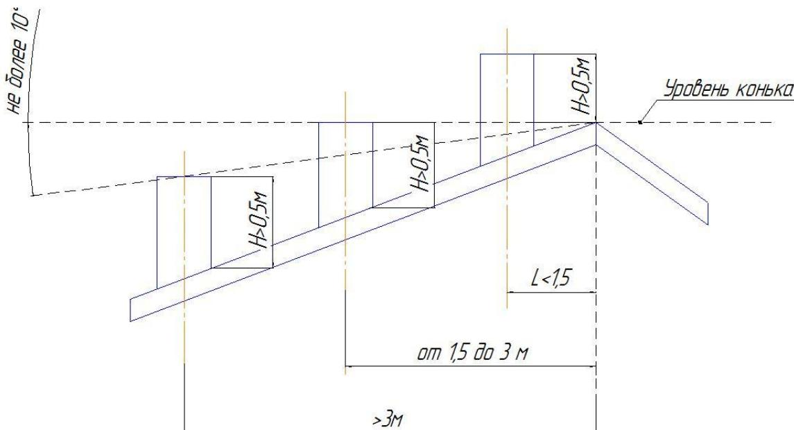
**Рисунок 7 – Варианты расположения трубы на скате**
