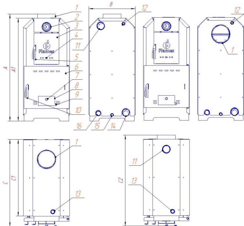
**Рисунок 2.2 – Общий вид и оснащение котлов GreenKOD-20, -15, -10 (-20 гт, -15 гт, -10 гт )**
