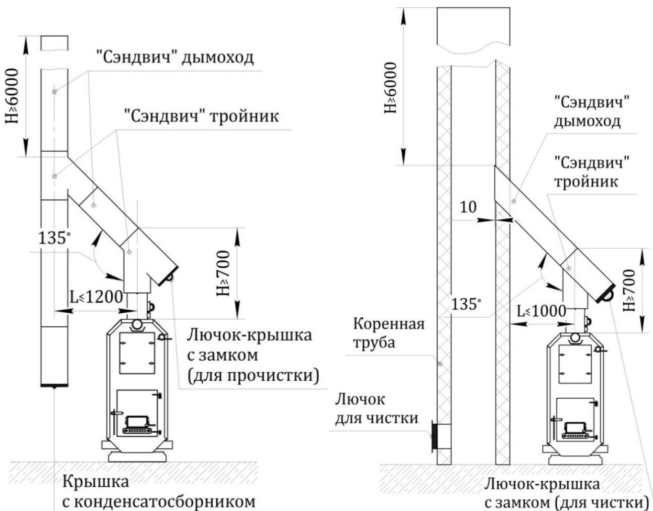
Рисунок 5 – Подключение котла с вертикальной дымовой трубой (2 варианта)
