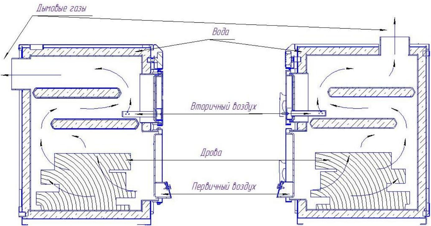
**Рисунок 1.2 – 2-х ходовая схема котлов GreenКОД-20, -15, -10 (справа)
